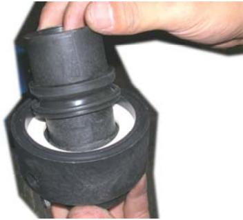
3. 將組立完成之乾式軸封組套入軸心，至馬達平面完成結合。
