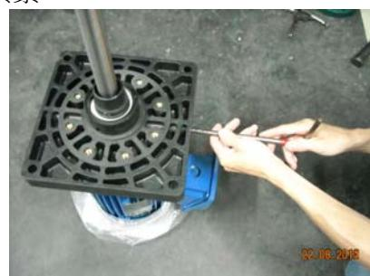
6. 在軸封蓋 O 環溝內微塗油脂放入 O 環。
