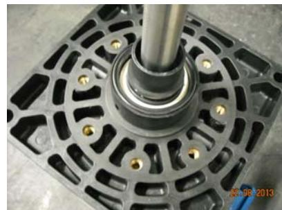
5. 軸封套上之螺絲孔對正馬達軸心下方之凹洞，再將螺絲鎖緊。
